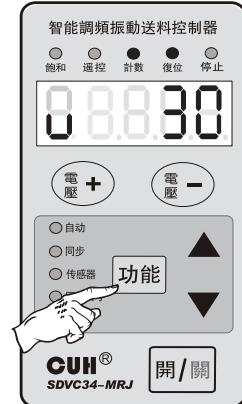
当计数进入末段计数状态时，控制器的送料速度将降为初始速度的百分比。
